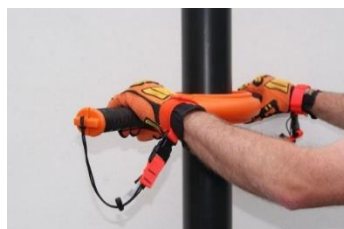
Ferramenta manual para movimentação e posicionamento de tubos e spools
