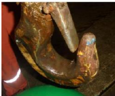
Exemplos de gancho com trava inadequada
